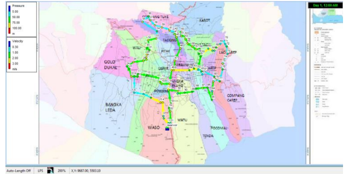
Gambar -1: Pembagian Loop Dengan Software Epanet
