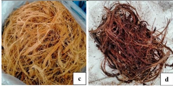
Gambar 5. Media Lekat Biofilm: (a) kulit buah siwalan sebelum pengolahan, (b) kulit buah siwalan setelah pengolahan, (c) serabut kelapa sebelum pengolahan dan (d) serabut kelapa setelah pengolahan
