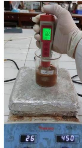
Gambar 3. Pengukuran nilai pH campuran
